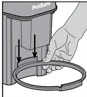
8. Retirez le porte-bol en libérant une languette à l'intérieur de la base du distributeur de nourriture à l'aide d'un ongle ou d'un tournevis tout en tirant doucement du même côté du porte-bol depuis l'extérieur. Libérez l'autre languette et tirez l'autre côté du porte-bol vers le bas.
