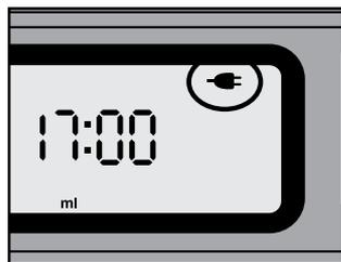
Si l'adaptateur est utilisé pour faire fonctionner le distributeur de nourriture, les piles fonctionnent comme une source électrique de secours en cas de coupure de courant. Lorsque l'adaptateur est utilisé comme source d'électricité, l'icône d'adaptateur apparaît en haut de l'écran LCD.
